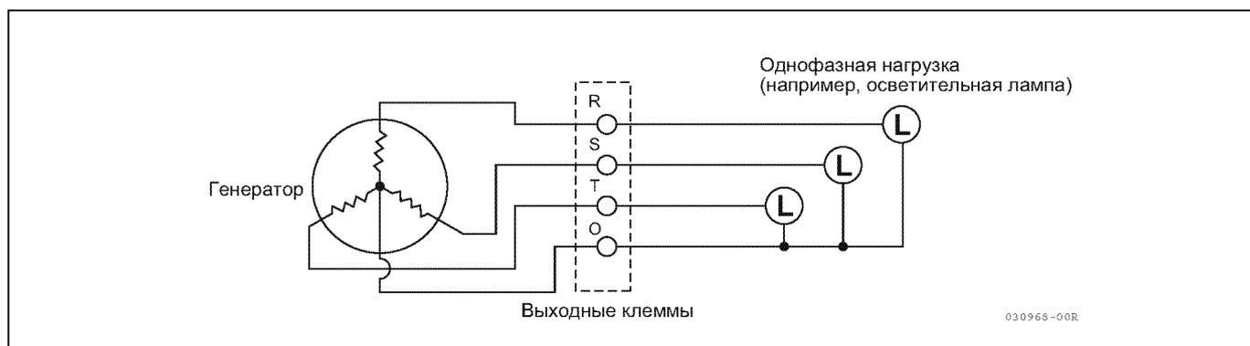
Нагружайте выход генератора так, чтобы каждая фаза была сбалансирована. Если нагрузка не сбалансирована, выдерживайте разность фаз в пределах 20%.
