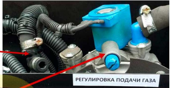
5. Регулировка (при необходимости). При пуске двигателя Вращайте «Регулировка выбора газа» влево-вправо до запуска станции. После запуска двигателя, добейтесь его устойчивой работы.
