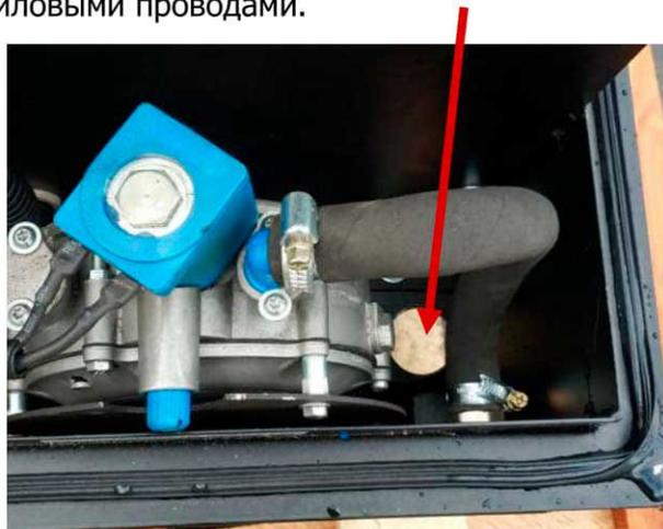
При наличии автоматики, так же заведите кабель управления и соедините с разъемом для автоматики.
