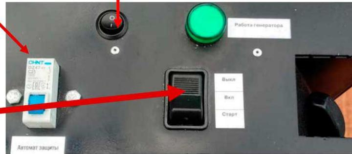
4. Для запуска генератора в ручном режиме установите перемычку между клеммами (замок зажигания и +12). Включите кнопку «старт» в положение ВКЛ и дождитесь её до включения эл.стартера. удерживайте её до запуска двигателя. Отпустите кнопку после запуска двигателя. Для выключения двигателя переведите кнопку запуска обязательно в положение ВЫКЛ. В ручном режиме ожидания, нахождение переключателя в положении ВКЛ запрещено.
