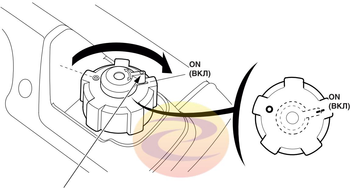
РЫЧАЖОК ВЕНТИЛЯЦИОННОГО КОЛПАЧКА ПРОБКИ
